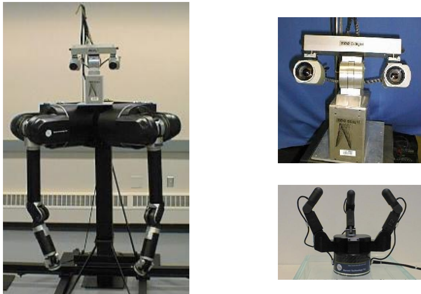
Fig. 1. Magilla – the UMASS Humanoid Torso.
